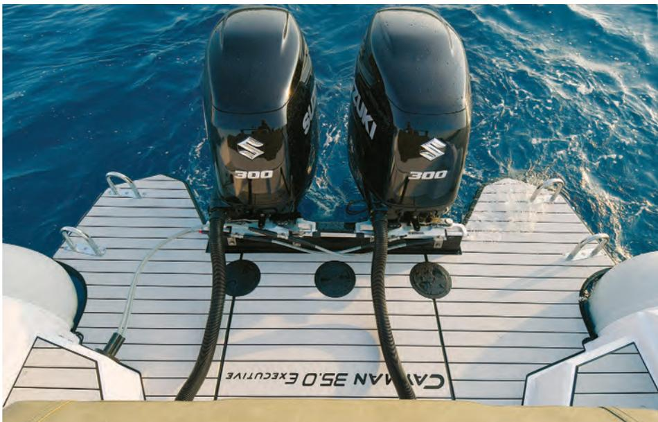
***L'ampia spiaggia balneare di poppa si appoggia su un bracket in alluminio su cui sono installati i fuoribordo e si estende ulteriormente attorno ai motori. Il rivestimento in materiale sintetico fa parte della dotazione standard. Il Cayman 35.0 è omologato per potenze fino a 900 cavalli.***
