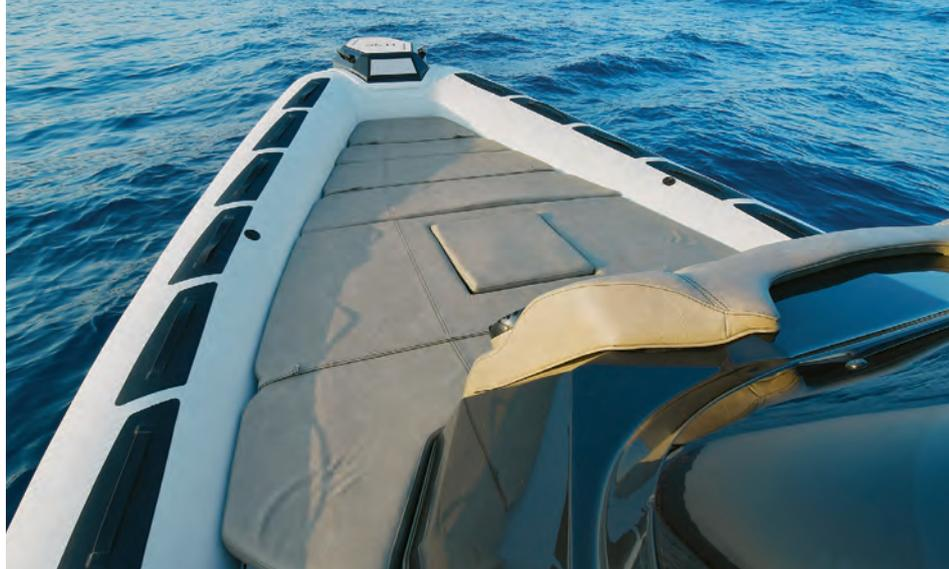
*Il musetto applicato serve solo per l'imbarco o i tuffi; è piccolo, ma non snatura la funzione della parte pneumatica. Il ponte è lungo, con tanta superficie per sdraiarsi. I materassini sono trattenuti da fasce di tessuto e un cuscino asportabile copre l'osteriggio. Comode le maniglie tessili sui tubolari.*
